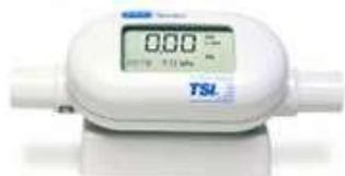
4146 calibrador primario método fio quente
